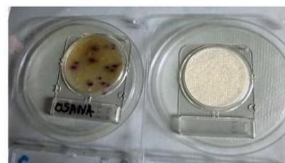
Die CompactDry Platten zeigen links wie schlecht das Wasser an Ort ist und die rechten Platten zeigen das in 5 Minuten bestrahltes Wasser jetzt E.Coli frei ist und jetzt als Trinkwasser benutzt werden kann.
