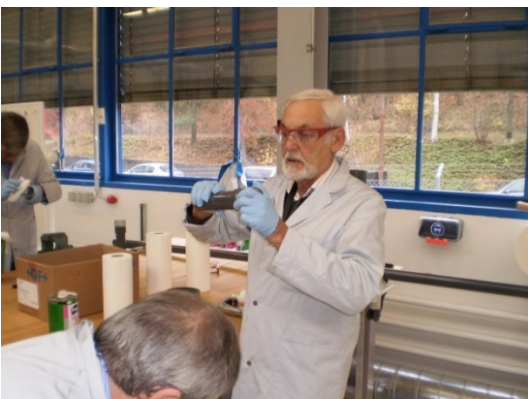
Roland Widmer übt die Verklebung zweier PVC Rohre.
