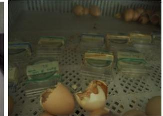
Für die Wasseranalyse wurden CompactDry Platten von NISSUI Pharma Japan verwendet und in einer Eierbrutanlage (Incubator) 24 Stunden bei 42°C getempert.
