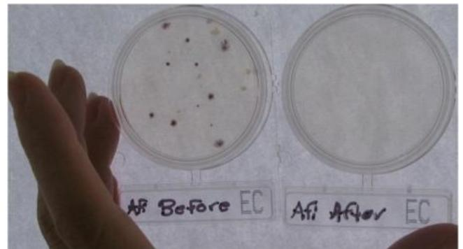
Unbehandeltes Wasser (links) ist mit 600 E. coli /100 sccm verseucht und nicht trinkbar. Nach der Behandlung (rechts im Bild) im Waterdrop 1 System (5 Minuten mit UVC-Strahlung in einer PET Flasche) ist es frei von E. coli und damit perfektes Trinkwasser
