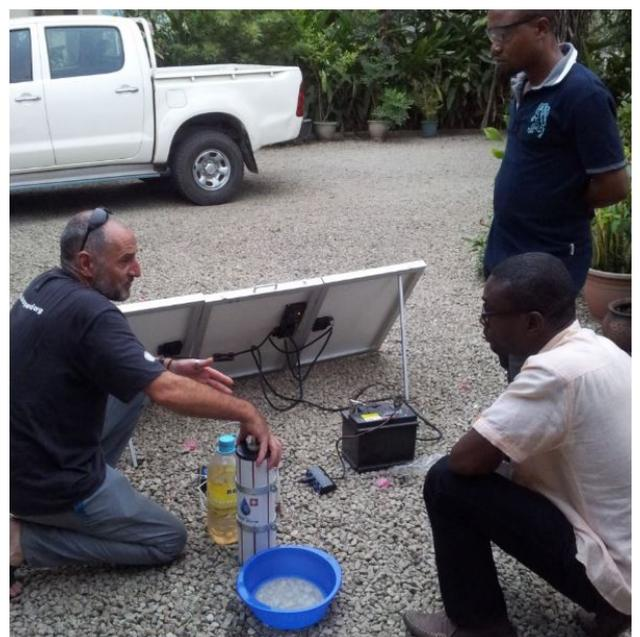
Das Waterdrop1 System wird mit Energie aus einem Solarpanel betrieben.
