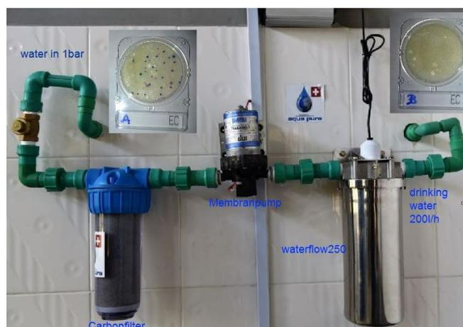
*Das Waterflow-System bestehend aus einem Carbonfilter, einer Wasserpumpe und dem Waterflow250 Filter. Es liefert bis zu 400 Liter bakteriologisch sauberes Trinkwasser pro Stunde.*
